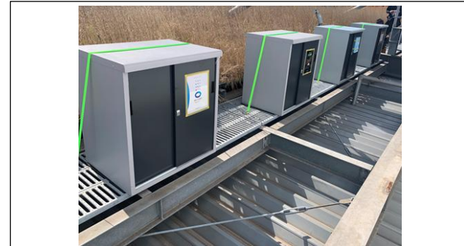
物置に市販の他社製断熱塗料とアミコートをそれぞれ塗布し、真夏の炎天下において内部温度推移を測定。
