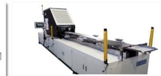
独自開発したオーロラフィン加工専用機。フィン間の幅を切削加工より狭められるため、多フィン化により冷却面積を増やされる。現在、最大で板材長2.5メートルまでのフィン連続成形が可能。
